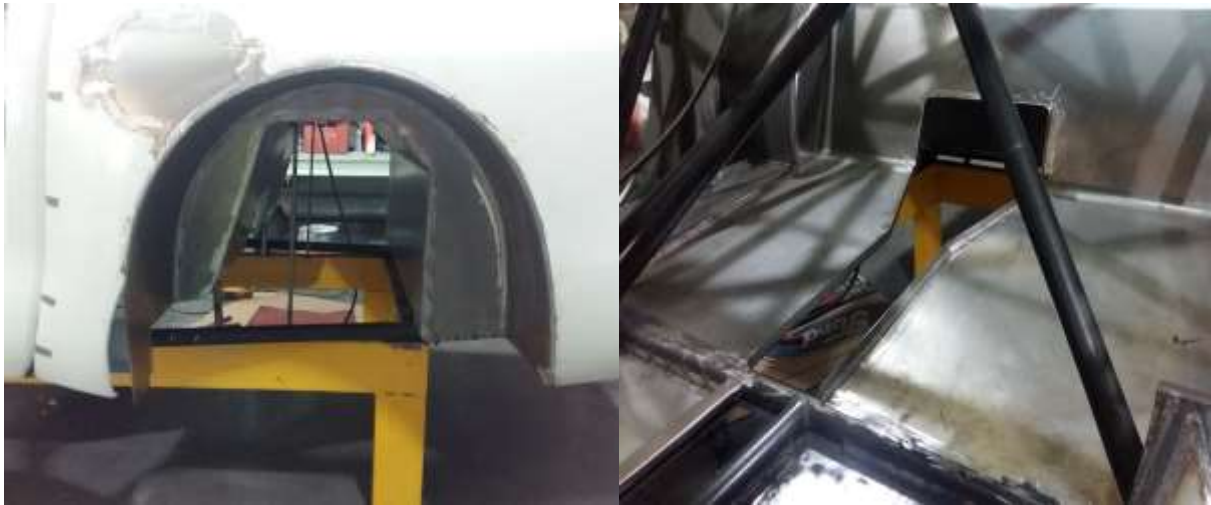
Salto de Diferencial vista lateral y vista desde el interior del habitáculo.
